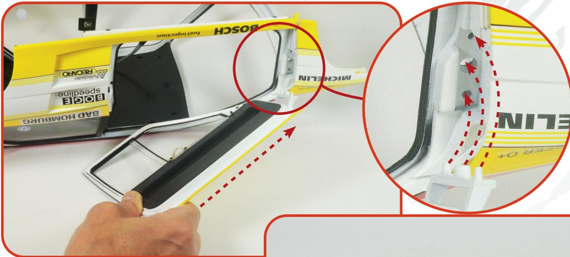
**05** Nehmen Sie die Karosserie Ihres Modells wieder zur Hand und legen Sie sie umgedreht auf Ihre Arbeitsfläche. Bringen Sie die linke Tür an der vorgesehenen Stelle an, indem Sie die Scharnierstifte in die entsprechenden Löcher in der Karosserie stecken. Befestigen Sie die Tür, indem Sie eine **VM**-Schraube im markierten Loch an der Innenseite der Karosserie anziehen.
