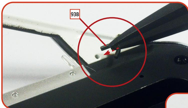
**04** Stecken Sie den Stift des Griffs **93B** in das auf dem Foto markierte Loch an der Innenseite der linken Tür. Wenn Sie möchten, können Sie einen Tropfen Kleber verwenden, um das Bauteil zu befestigen.
