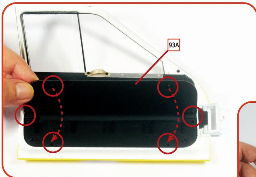
**03** Bringen Sie die Türverkleidung **93A** an der gezeigten Stelle am unteren Teil der Türinnenverkleidung an. Setzen Sie dabei die Stifte in die entsprechenden Löcher ein und üben Sie leichten Druck auf die gesamte Oberfläche des Teils aus, um es korrekt zu befestigen.
