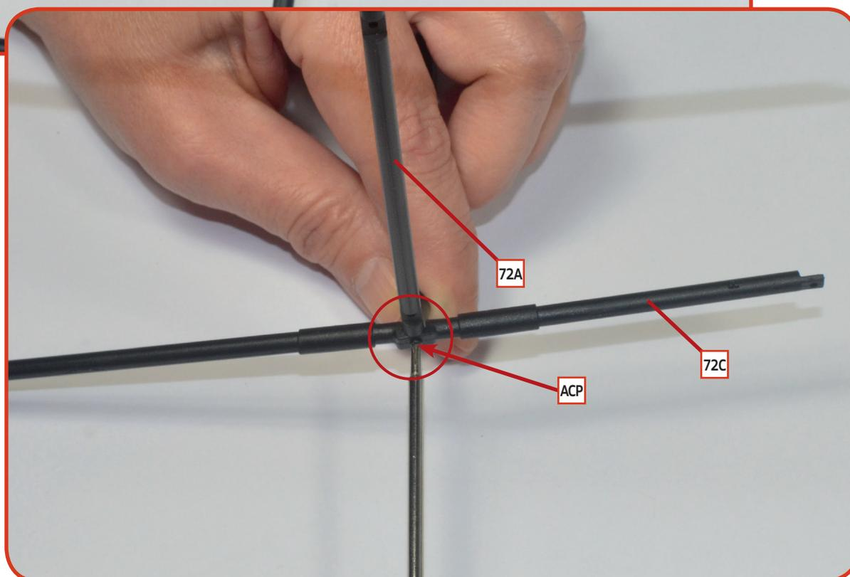
**03** Verbinden Sie auf die gleiche Weise die rechte hintere Stütze **72C** (mit dem Buchstaben „R“ gekennzeichnet) mit dem Mittelteil des Überrollkäfigs **72A** und befestigen Sie sie mit einer **ACP**-Schraube.
