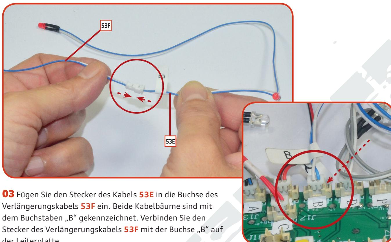
**03** Fügen Sie den Stecker des Kabels **53E** in die Buchse des Verlängerungskabels **53F** ein. Beide Kabelbäume sind mit dem Buchstaben „B“ gekennzeichnet. Verbinden Sie den Stecker des Verlängerungskabels **53F** mit der Buchse „B“ auf der Leiterplatte.
