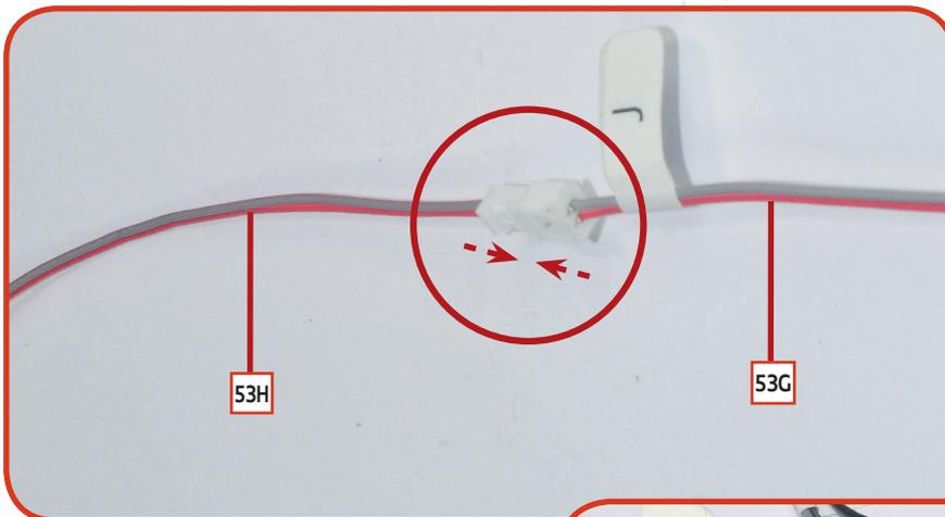
**04** Fügen Sie den Stecker des Kabels **53G** in die Buchse des Verlängerungskabels **53H** ein. Beide Kabelbäume sind mit dem Buchstaben „J“ gekennzeichnet. Verbinden Sie den Stecker des Verlängerungskabels **53H** mit der Buchse „J“ auf der Leiterplatte.
