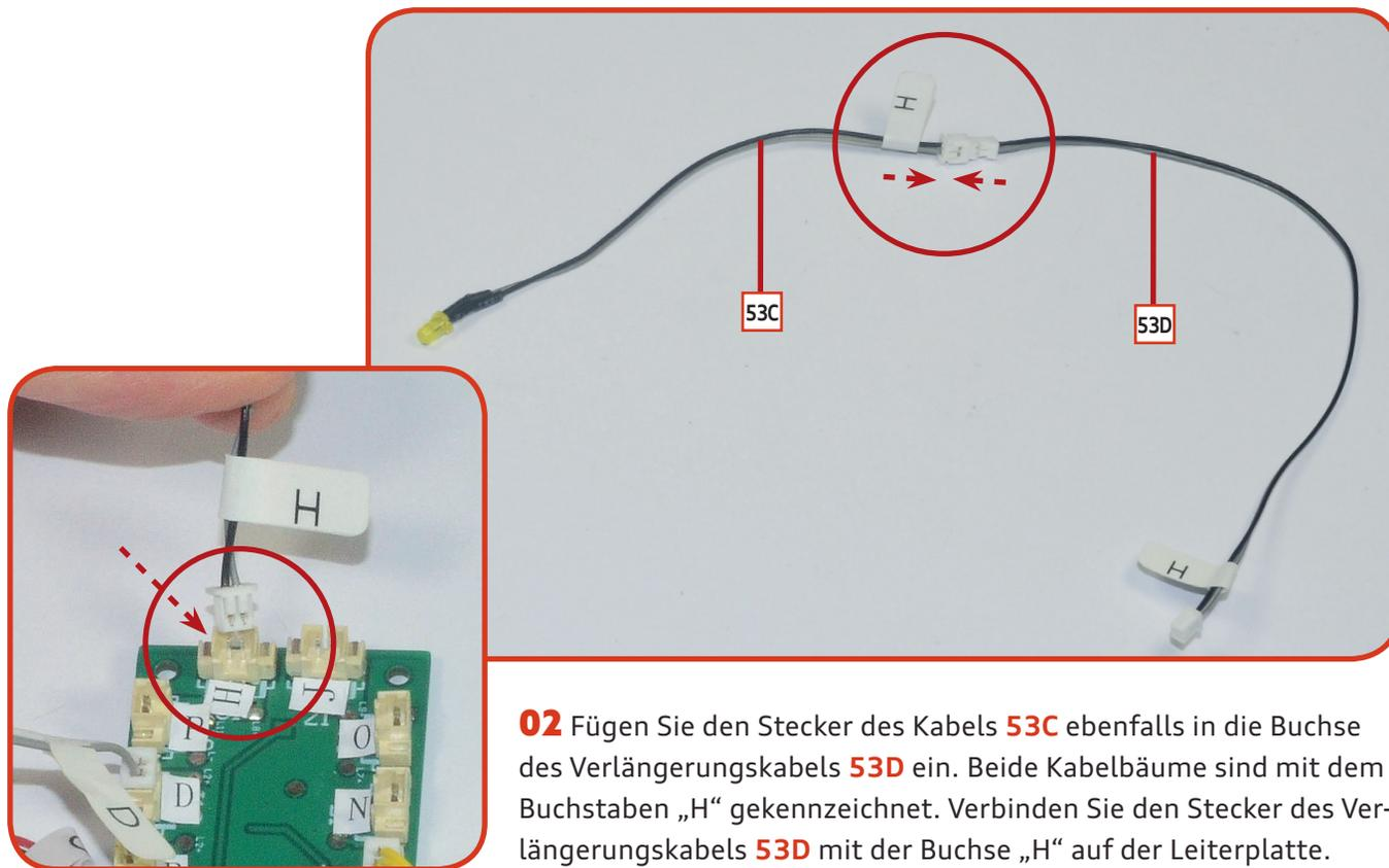
**02** Fügen Sie den Stecker des Kabels **53C** ebenfalls in die Buchse des Verlängerungskabels **53D** ein. Beide Kabelbäume sind mit dem Buchstaben „H“ gekennzeichnet. Verbinden Sie den Stecker des Verlängerungskabels **53D** mit der Buchse „H“ auf der Leiterplatte.
