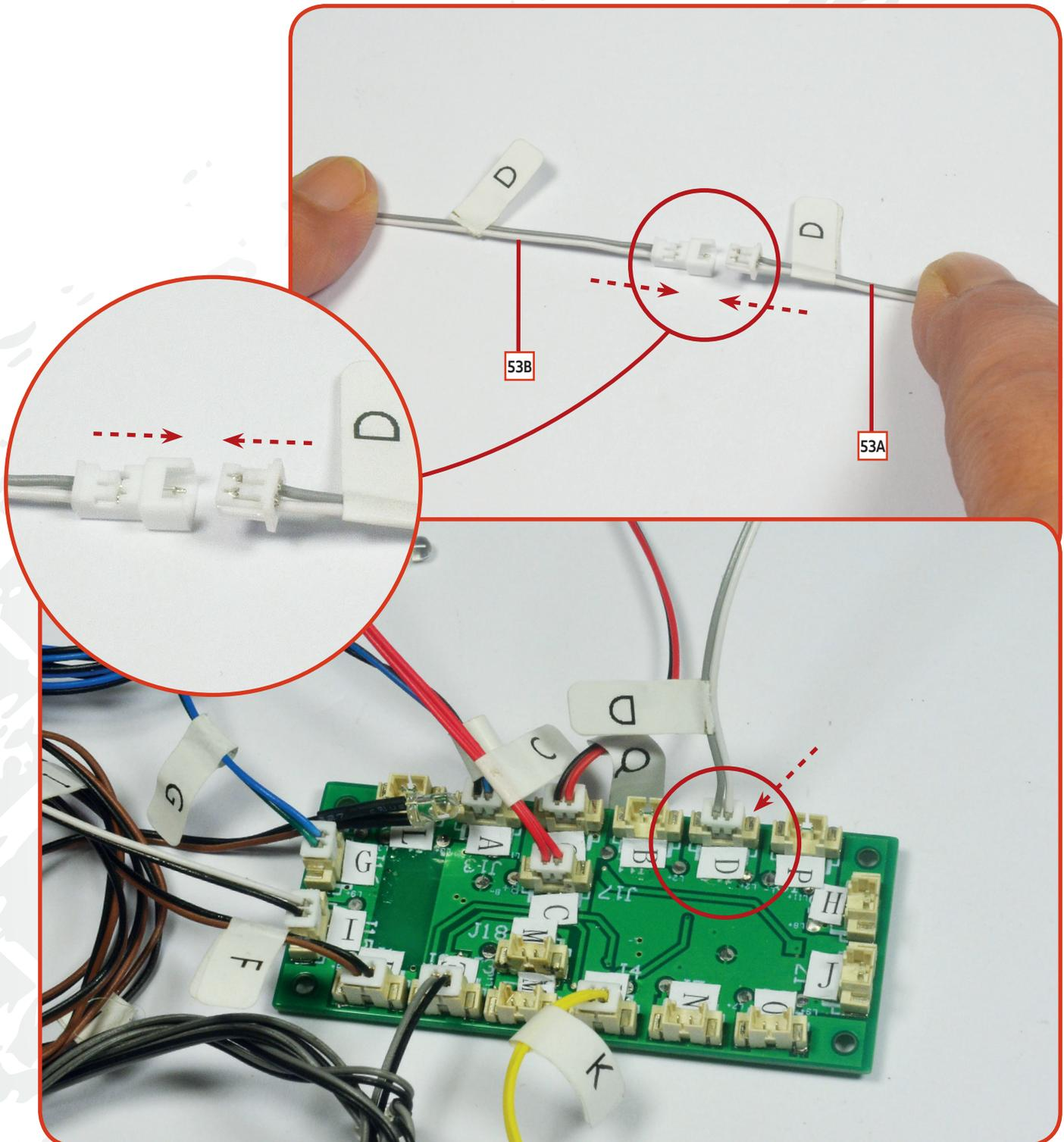
**01** Fügen Sie den Stecker des Kabels **53A** in die Buchse des Verlängerungskabels **53B** ein. Beide Kabelbäume sind mit dem Buchstaben „D“ gekennzeichnet. Verbinden Sie den Stecker des Verlängerungskabels **53B** mit der Buchse „D“ der Leiterplatte **51A**.
