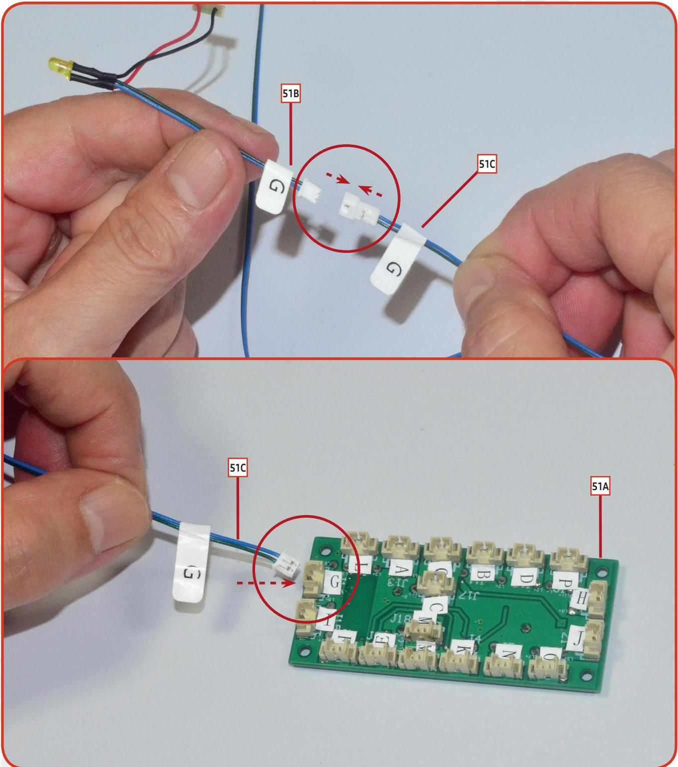
**01** Stecken Sie den Stecker des Kabels **51B** in die Buchse des Verlängerungskabels **51C**. Beide Kabelbäume sind mit dem Buchstaben „G“ gekennzeichnet. Stecken Sie den Stecker des Verlängerungskabels **51C** in die Buchse „G“ der Leiterplatte **51A**.
