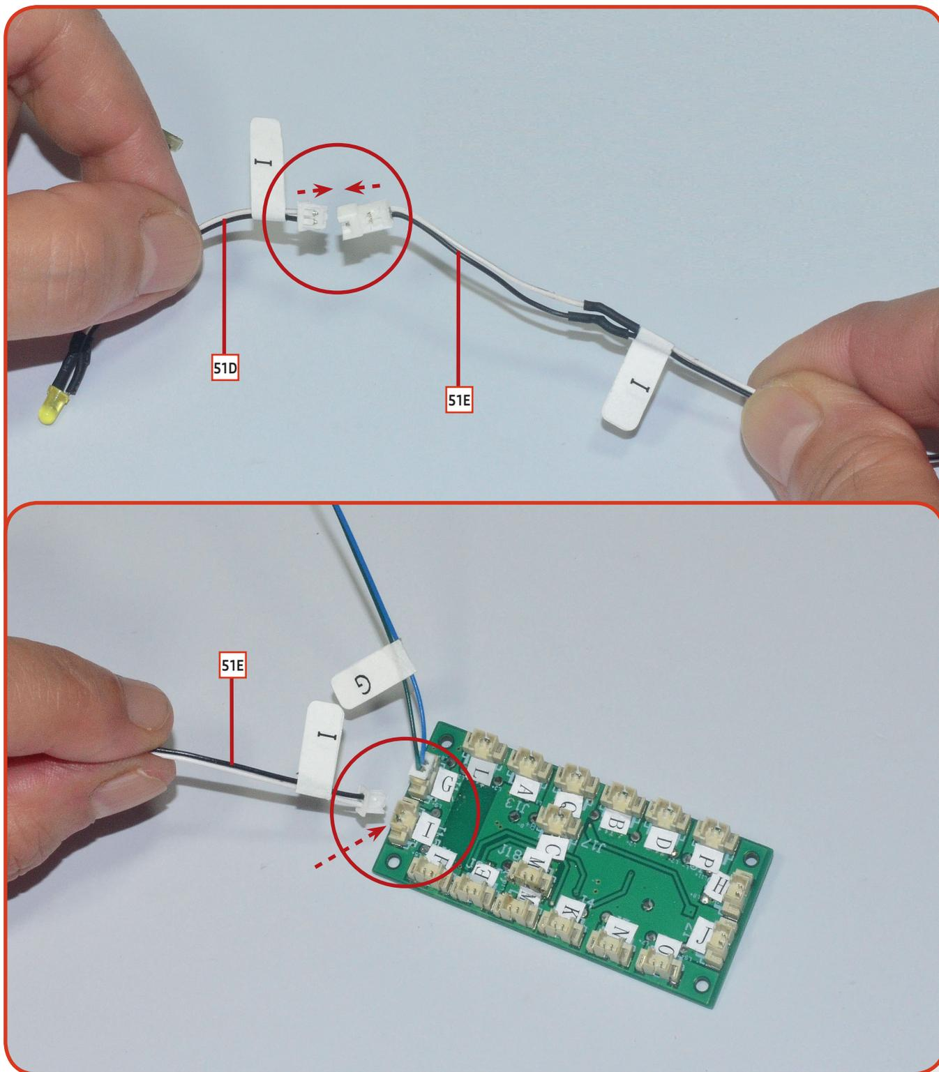
**02** Stecken Sie den Stecker des Kabels **51D** ebenfalls in die Buchse des Verlängerungskabels **51E**. Beide Kabelbäume sind mit dem Buchstaben „I“ gekennzeichnet. Stecken Sie den Stecker des Verlängerungskabels **51E** in die Buchse „I“ auf der Leiterplatte.
