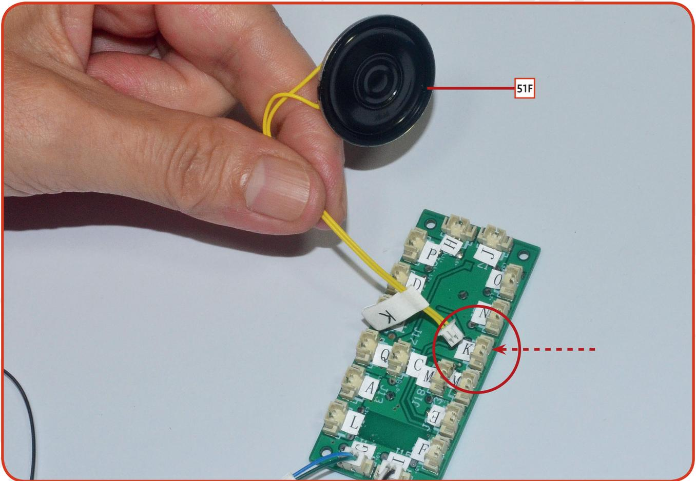
**03** Stecken Sie den Stecker des Lautsprecherkabels **51F** in die Buchse „K“ auf der Leiterplatte.
