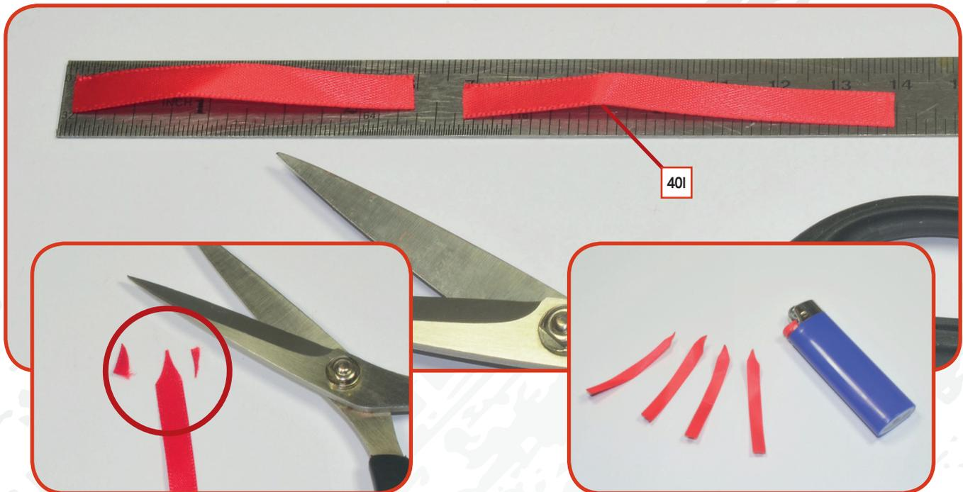
**01** Schneiden Sie das Gurtband **40I** mit einer Schere und einem Lineal in vier Streifen zu je 56 mm Länge. Schneiden Sie ein Ende jedes Streifens mit der Schere spitz zu. Um überstehende Fäden zu vermeiden, können Sie die Enden vorsichtig mit der Flamme eines Feuerzeugs verschmelzen, ohne sie direkt zu berühren. Achten Sie darauf, dass die Streifen nicht mit der Flamme in Kontakt kommen, da das Material brennbar ist.
